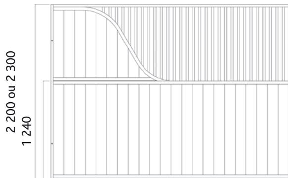
Cadre en acier galvanisé à chaud remplissage en govoplast. Dimensions standards : 3m, 3,5m et 4m. possibilité sur-mesure. Option bois exotique ou bambou. peinture epoxy.
